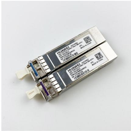
Huawei SFP-10G-BXD1 10GBase, BIDI 光トランシーバー, SFP+, 10G, シングルモード モジュール (TX1330nm/RX1270nm, 10km, LC)
