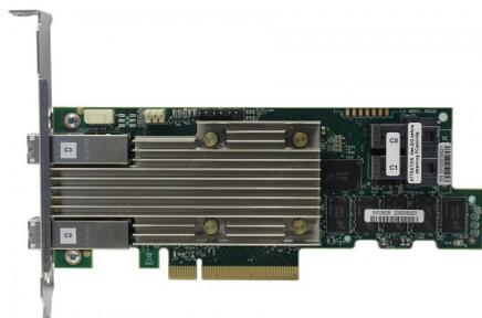
Broadcom LSI 9480-8i8e 05-50031-00 PCIe 3.1 x8 SAS3516 8 内部 & 8 外部ポート MegaRAID トライモード ストレージ アダプタ
