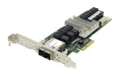
Adaptec AEC-82885T 2283400-R 12Gb/s PCIe 3.0 x4 36 ポート (内部 28/外部 8) SAS エキスパンダー カード AEC-82885T
