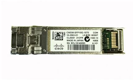
Cisco CWDM-SFP10G-1570 CWDM 1570 nm SFP+. 10 ギガビット イーサネット
