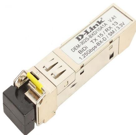
D-Link DEM-302S-BXD SFP トランシーバー 1 ポート 1000Base-BX SMF 用、電源 3.3V (最大 2km)、WDM (TX: 1550nm、RX: 1310nm)
