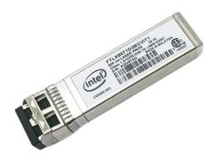
Intel FTLX8571D3BCVIT1 10G SFP+ SR 光トランシーバー モジュール
