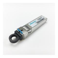
純正 Hisense LTE3468L-BHG+ GPON ONU クラス B+I 20km SFP モジュール 34060565
