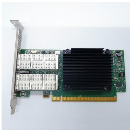
Mellanox MCB194A-FCAT Connect-IB デュアル QSFP+ ポート PCI Express Gen3 x16 アダプター カード
