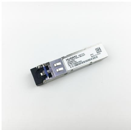
Huawei 光トランシーバー (eSFP、1550nm、1.25Gb/s、-2dBm ~ 5dBm、-23dBm、LC、SM、80km)
